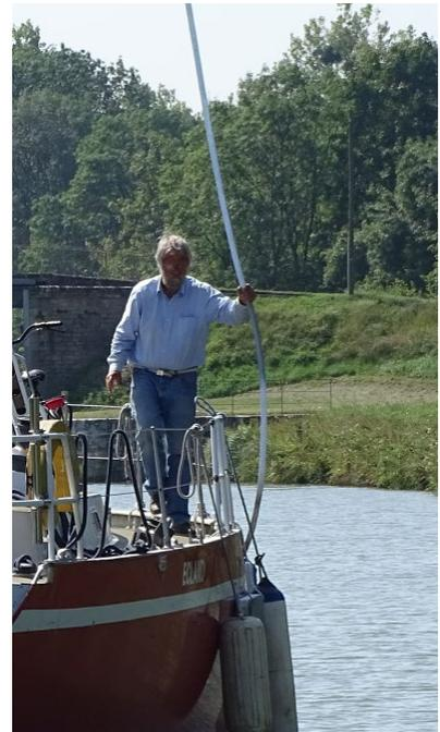
Le pertiche di manovra delle chiuse automatiche sulla Saône, posizionate a un centinaio di metri da ogni lato della chiusa, con tanto di cartello esplicativo sul funzionamento. A destra, André durante la manovra per lanciare il *bassinage*.
